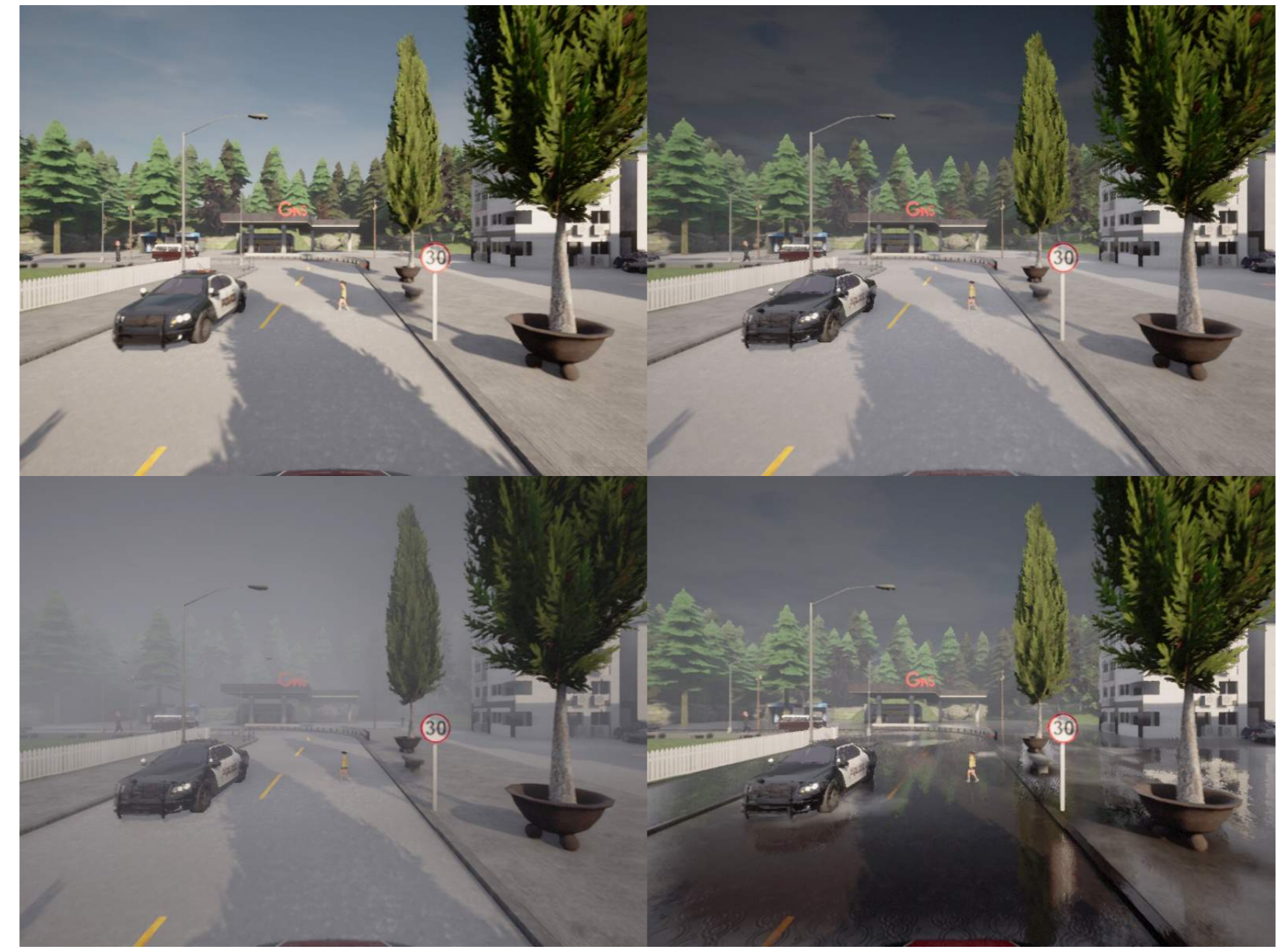
Figure 2: Depiction of the same scene in the CARLA traffic simulator for different weather parameters. (© Deutsches Zentrum für Luft- und Raumfahrt e.V.)
